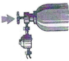
ЗАКРЫТЬ КРАН НА ОТВОДЕ К ГАЗОВЫМ ПРИБОРАМ
